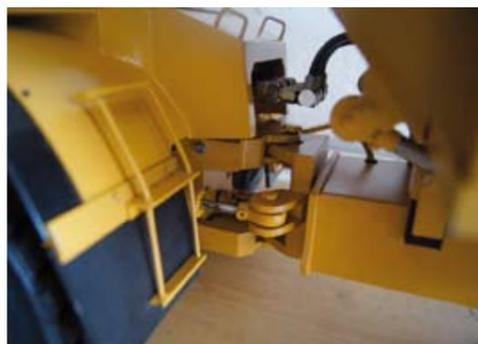
Kardanwelle und Knicklenkung entsprechen dem Original.
