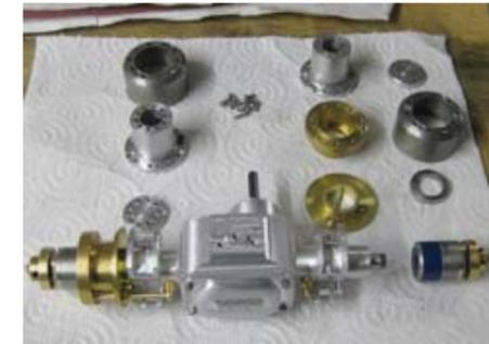
Eine Achse in Einzelteilen.
