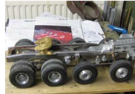
Bei der Zugmaschine des MAN sind beide Vorderachsen lenkbar – wie beim Original.
